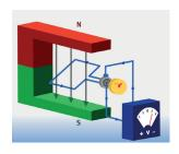
Im Draht befinden sich Elektronen, die mit der Spule mitbewegt werden, wenn sich die Spule dreht. Aufgrund des Magnetfeldes durch den Hufeisenmagneten wirkt auf diese mitbewegten Elektronen eine Kraft in Drahtrichtung; es entsteht eine Spannung an den Enden der Spule.
