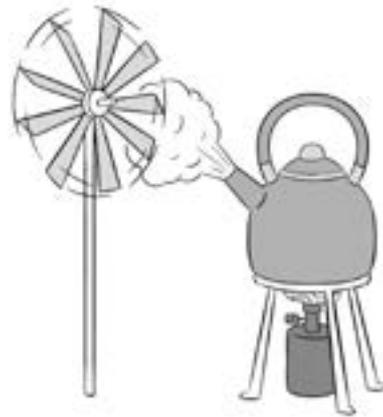
In einem Wärmeleistungwerk wird die Kraft des heißen Dampfes genutzt.
